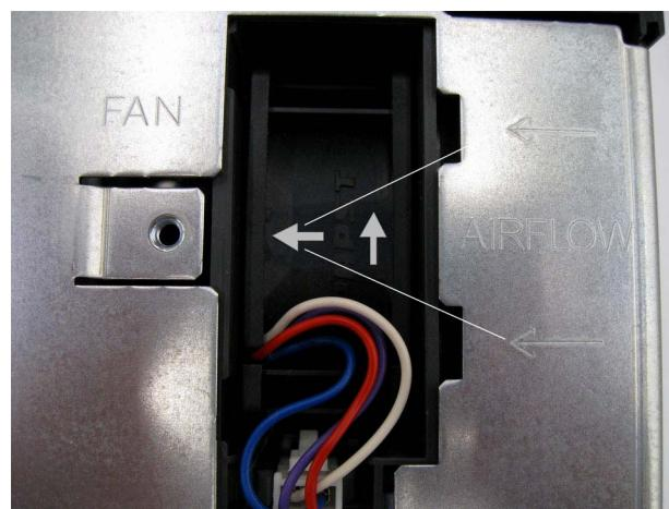
图 14-1 风扇上的气流方向箭头
