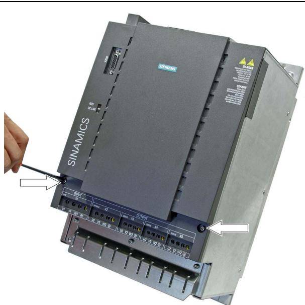
取出正面的两个 Torx 带槽螺钉
