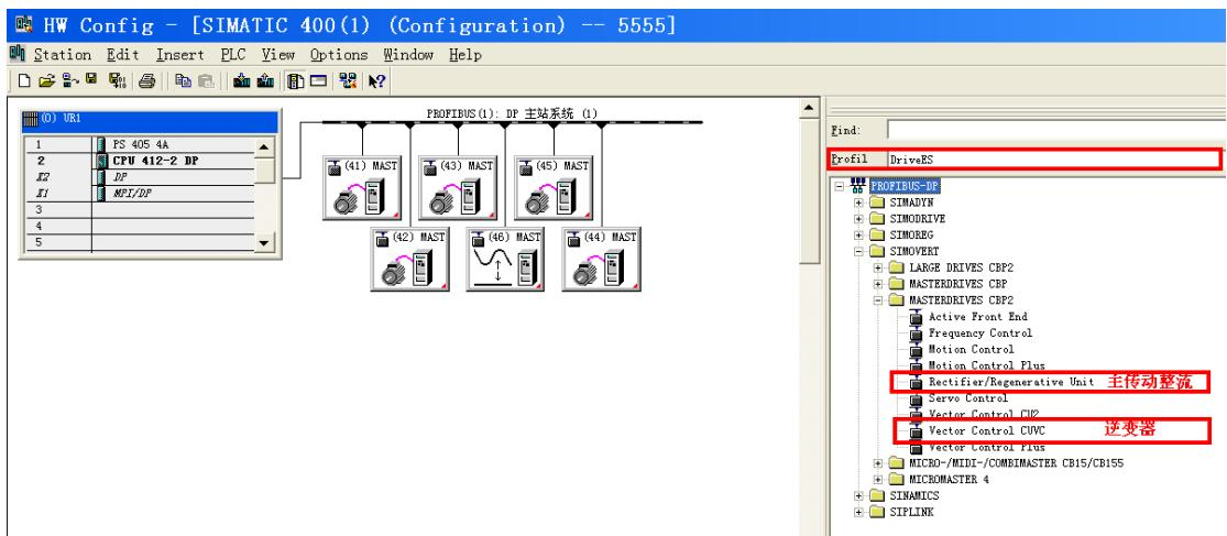
3) 编程线连接变频器时，需要将变频器的 DP 头拆下进行连接（缺点需要停机，DP 头改为带编程口的就不用拆了），否则连不上；PG/PC 接口利用 Profibus-DP 方式连接；主传动整流连接备份参数时，出现不能读取参数错误，检查发现 P053=12 (8+4) 改为 P053=13 (8+4+1) 即可在线；
