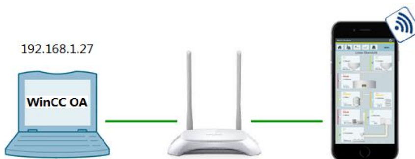
图 1 Mobile UI 在局域网中连接 WinCC OA 示意图
