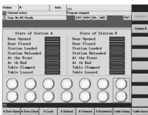
图2 应用HMI开发包为某机床开发的操作界面
