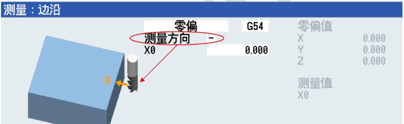
3) 设定零偏。当确认刀具边缘已经与工件毛坯相接触，就可以按下屏幕右边【设置零偏】
