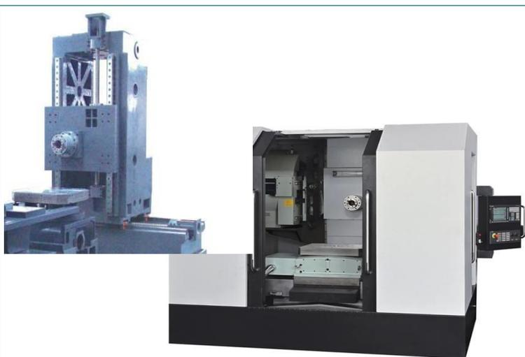
卧式数控铣床的主轴轴线平行于水平面，主要用来加工零件的侧面。工件经过一次装夹，数次转动而完成多方位的加工，特别在箱体类零件加工中具有明显的优势。
