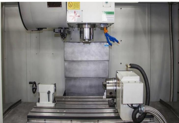
立式数控铣床是数控铣床中最常见、应用范围也最广泛的一种布局形式，其主轴轴线垂直于水平面。此类机床以三轴联动居多，若附加一个旋转坐标，还可以转变为四轴联动立式数控铣床（如图）。
