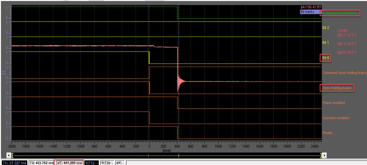
380V 断电，电源模块报警 207862，206200，伺服 OFF1=0，抱闸打开 r899.12=0，15ms 后，外部继电器刹车返回信号 =0
