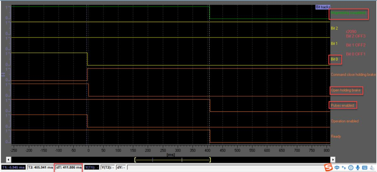
380V 断电，电源模块报警 207862，A 轴不动
