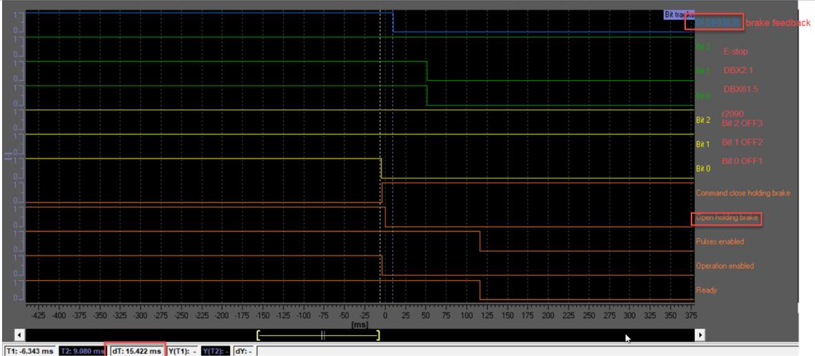
外部继电器刹车返回信号 = 0, 100ms 后, 驱动脉冲使能 r899.11 = 0
