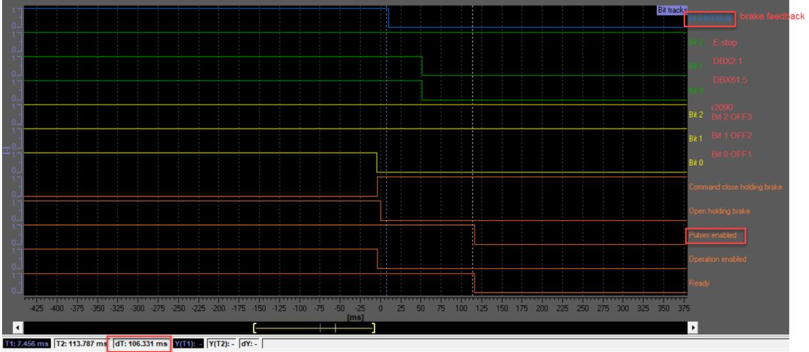
380V 断电, 电源模块报警 207862, 伺服 OFF1=0, 抱闸打开 r899.12=0, 延时 140ms 后, 驱动励磁完成 r56 bit 4 = 0
