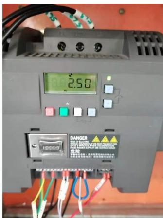
图 10 变频器调试频率显示
