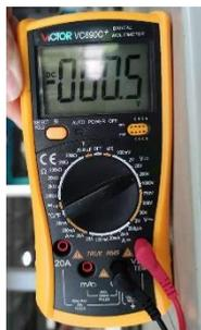
图 11 万用表量测模拟电压值
