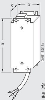
适合 A 型外形尺寸变频器的进线电抗器
