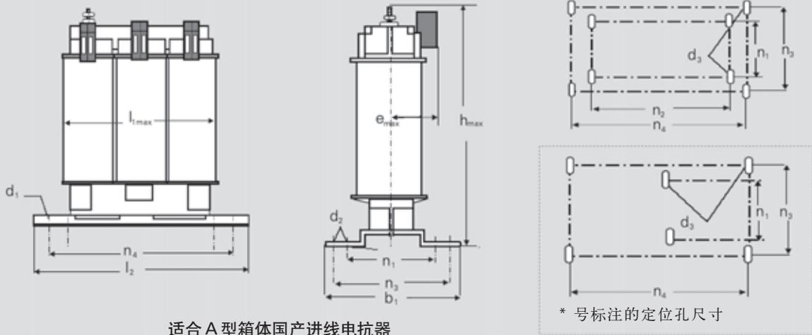
适合 A 型箱体国产进线电抗器
