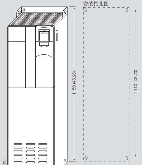
带有内置滤波器的 F 型外形尺寸变频器
