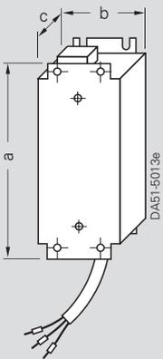
适合 A 型箱体尺寸的进线电抗器
