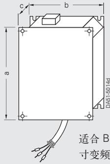
适合 B 型和 C 型外形尺寸变频器的进线电抗器
