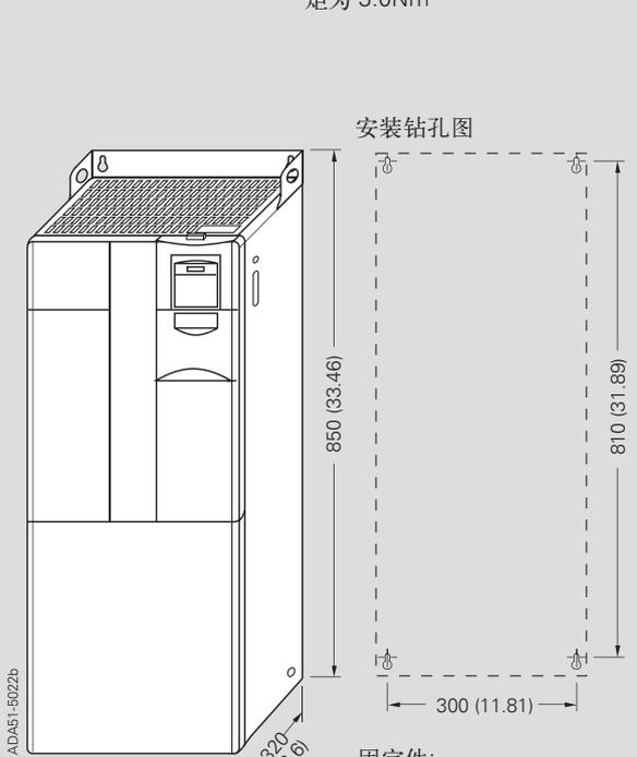
无滤波器的 F 型外形尺寸变频器
