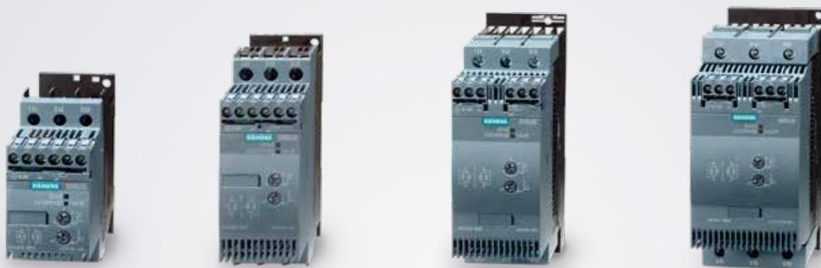
如果电机启动时直接输出的功率过大，则会伴随着众多问题。诸如加热鼓风机的皮带打滑或工业清洗系统中的水压冲击。然而，这些问题都可使用控制电机功率高达 55 kW（400 V）的 SIRIUS 3RW30 加以解决。另外，SIRIUS 3RW30 还是业内设备中，可以和同家族中同规格低压产品具有相同宽度的软启动器，因此，能够很方便地从直接启动改造为软启动。
