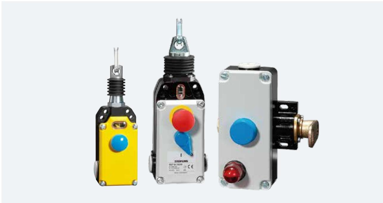
SIRIUS 拉绳开关 3SE7 可满足所有要求：带或不到闩锁装置，用于作为符合 ISO 13850 (EN 418) 的完整急停系统的信号装置；或带有集成急停按钮。强制断开触点安全可靠，一旦发生断线或被拉动，触点就会打开并中断电路。并且，这些拉绳开关可通过开关上的一个位置指示器精确调节至毫米精度。
