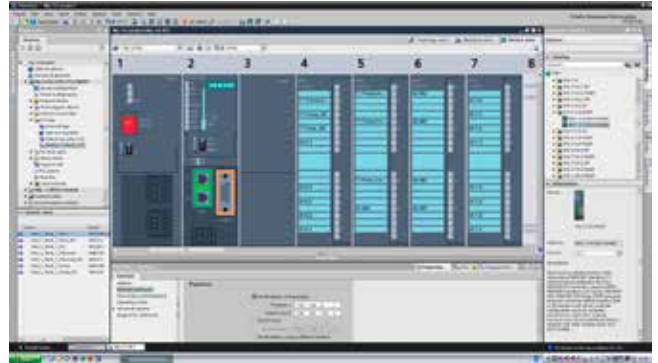
设备视图 —— 以逼真的观感进行硬件组态
